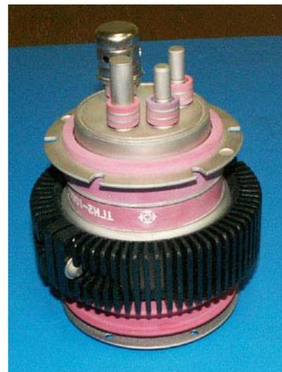
Примечание: тиратроны работают при частоте повторения импульсов до 50000 имп/с при условии снижения импульсной и средней мощности.
