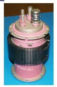
Примечание: тиратроны работают при частоте повторения импульсов до 50000 имп/с при условии снижения импульсной и средней мощности.
